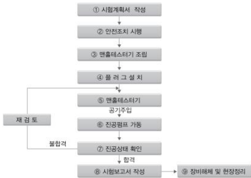
[그림 2-8-8] 맨홀 부공기압(진공시험) 절차모식도
