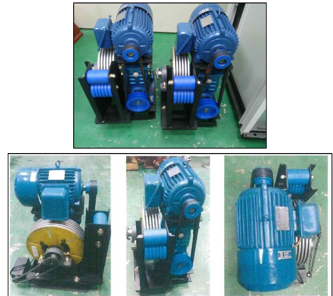
와이어 디스크형 드럼 보호수단이 구비된 디스크형 드럼구동장치
