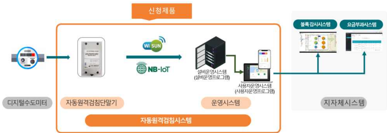
[그림 1] 자동 원격검침시스템의 구성 원리
