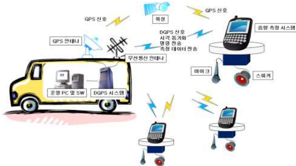
[그림 1-1-14] 통합시스템의 구성
