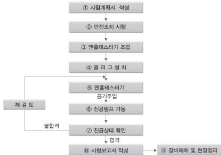
[그림 2-8-8] 맨홀 부공기압(진공시험) 절차모식도
