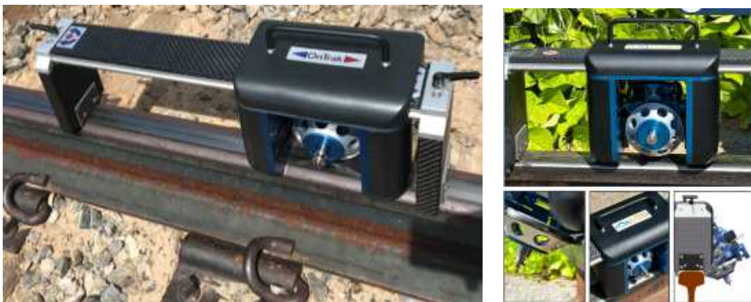
Fig. 1: 휴대용 레일 마찰크립곡선 측정기 (Portable rail tribometer).
